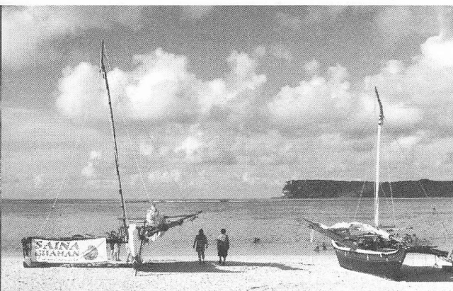
写真2 ミクロネシアの航海カヌー （左が復元チャモロ型、右が西カロリン型）
